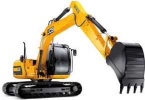
Figura 4: na lagarta da escavadeira, a pressão é menor do que seria se usasse pneus
